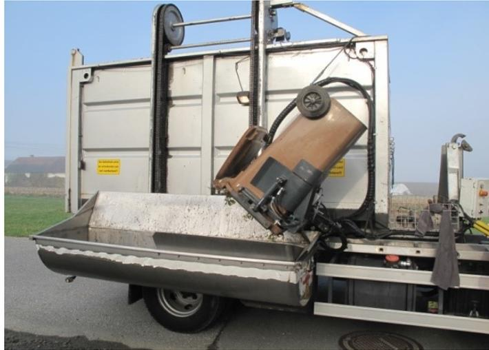
**Abbildung 33: Vorrichtung zur Schüttung des Bioabfalls sowie Schüttwanne zur anschließenden Qualitätskontrolle in der Gemeinde Dobl-Zwaring. (Eigene Aufnahme, Dobl-Zwaring, 31.10.2016)**
