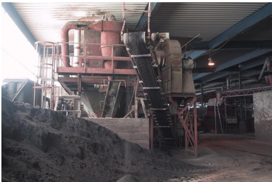
**Abbildung 16: Sortiermaschine in einer geschlossenen Kompostanlage. (Dachverband AWV 2017)**
